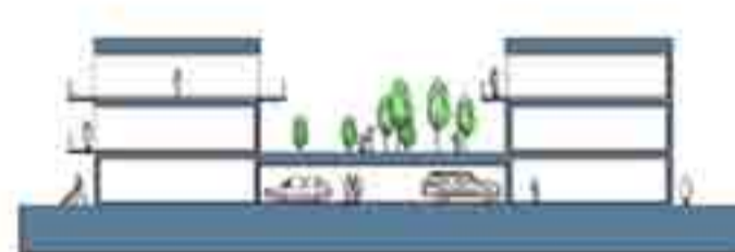
Principssnit, parkering mellem bygninger mål 1:500
