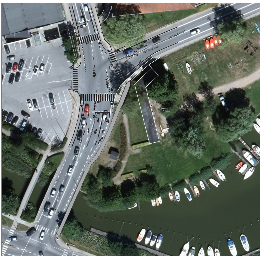
Fig. 8 Skitse der viser eksempel på princip for udvidelse af Hertug Hans bro med en fod- og cyklistforbindelse langs den østlige del af broen.
