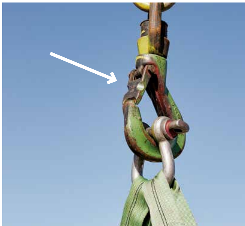
Afhængningssikringen skal ALTID være på krankrogen, da den sikrer at byrden ikke afhægter under kraning.
