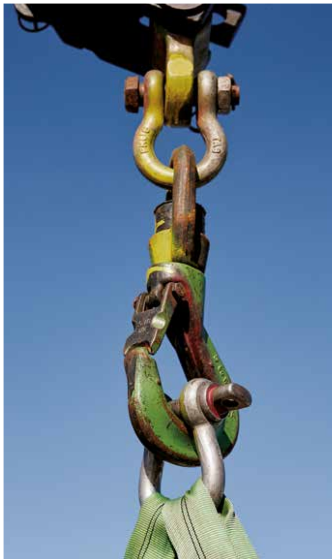
Ofte bruges sjækkel når grej skal samles, f.eks. i rundslæng. Sjækkelbolten lægges over krogen og stropperne samles i buen.
