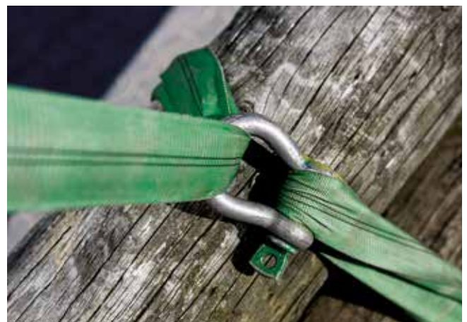
En almindelig sansning med strop med en WLL på 2 ton. Sansningen reducerer WLL med 20%, dvs. stropens nye WLL er 1,6 ton.
