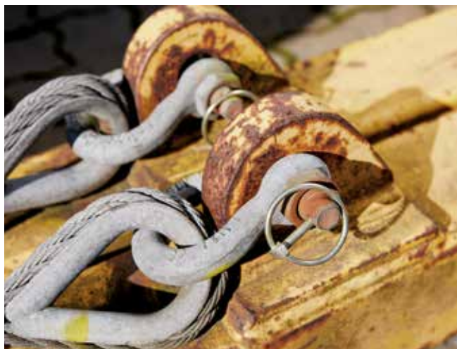
Er sjæklen monteret permanent, f.eks. i et åg, skal den være forsynet med låsesplit.
