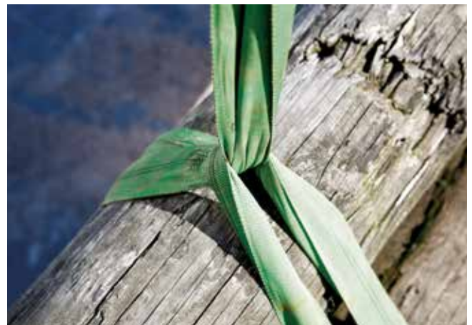
En almindelig sansning med strop med en WLL på 2 ton. Sansningen reducerer WLL med 20%, dvs. stropens nye WLL er 1,6 ton.
