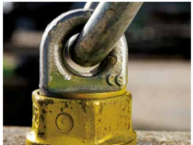
Alt løfttilbehør til anhugning skal være CE-mærket. Bemærk den gule årsfarve.
