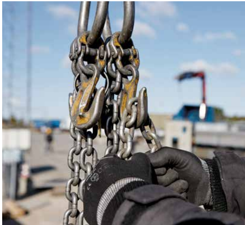
Den lille krog i toppen af kædeslinget bruges hvis kæden skal kortes op.
